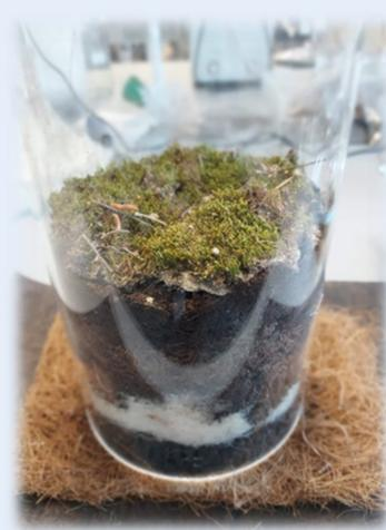
Una capa fibrosa que permite la captura del material particulado y además estructura el sistema haciendo de separación entre las otras capas.
